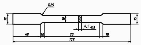
Отбор образцов для механических испытаний проводят по ГОСТ 24047-80.
